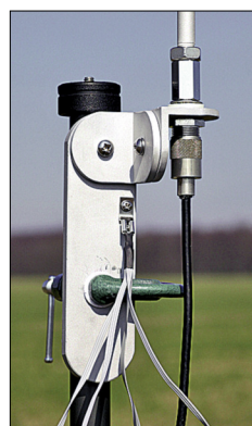
Bild 5: Montagewinkel mit Antenne, Koaxialkabel und vier Radialen
