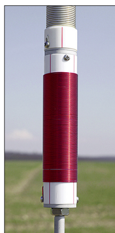
Bild 4: Verlängerungs- spule für das 80-m-Band
